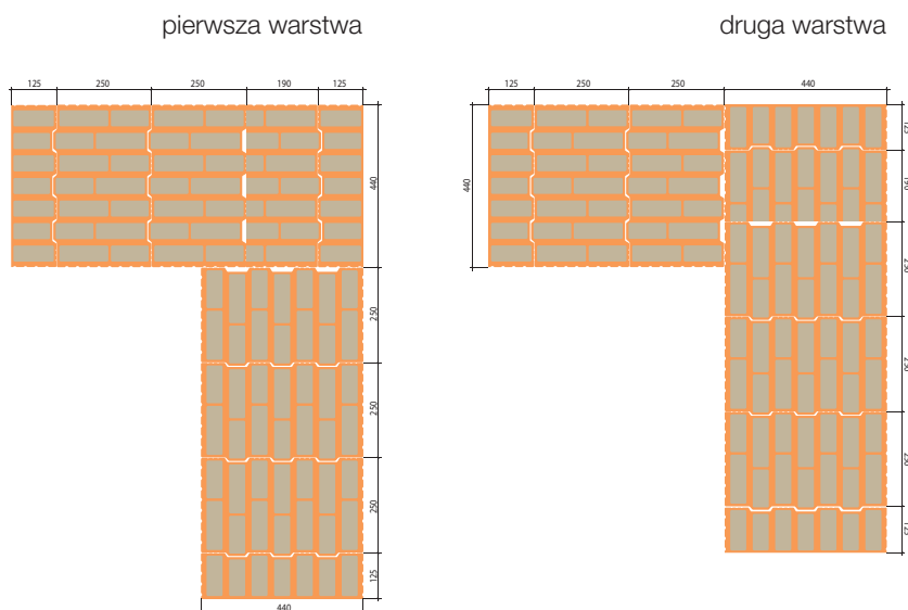
połączenie Porotherm 44 T Profi / Dryfix w narożniku
