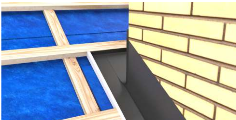
Obróbkę tylną należy wyprofilować w taki sposób by mogła zostać zamocowana do czoła pierwszej łąty za kominem.
