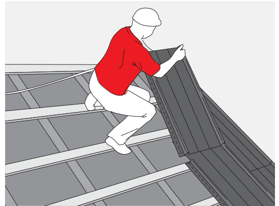
RYS. 27. UKŁADANIE KOLEJNEGO PANELU NA ZAKŁAD
