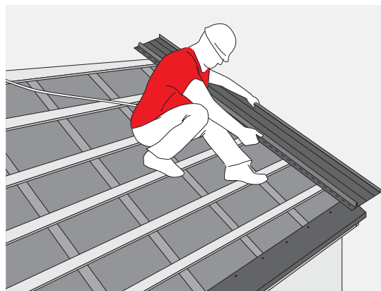
RYS. 16. UKŁADANIE PANELI DACHOWYCH
